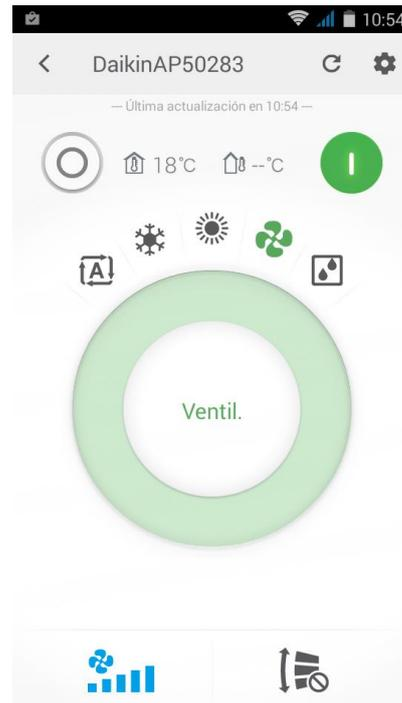
2.19.- Para controlar la unidad sin conexión WiFi, debe activarse el modo "fuera de casa". Tendremos que enlazar el adaptador BRP al router de la vivienda y darnos de alta en el servidor para manipular la unidad fuera de la vivienda.
