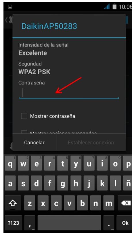
2.13.- Se establecerá la conexión entre el adaptador BRP y el Smartphone o Tablet:
