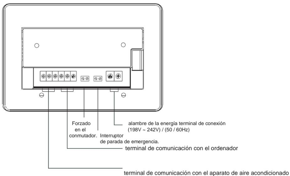
Fig.1.3 Terminal de controlador centralizado
