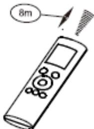
Cuando se activa el temporizador, el mando a distancia transmite automáticamente una señal a la unidad interior en el momento que se ha especificado. Si se mantiene el control remoto en una posición que dificulta la transmisión adecuada de la señal, se puede producir un retraso de hasta 15 minutos.
