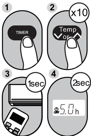
Nota: Cuando ajuste el temporizador de encendido / apagado, en periodos de hasta 10 horas, el tiempo aumentará en incrementos de 30 minutos con cada pulsación. En periodos de 10 a 24 horas, aumentará en incrementos de 1 hora. El temporizador volverá a cero después de 24 horas.
