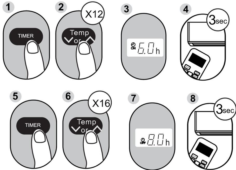
Ejemplo: Programación de la unidad para el encendido después de 6 horas, funcionar durante 2 horas y, a continuación, apagarse. (Vea la figura siguiente)
